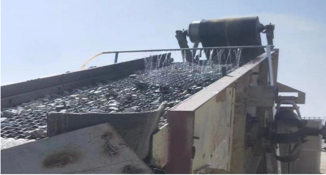
转运落料洒水降尘照片
